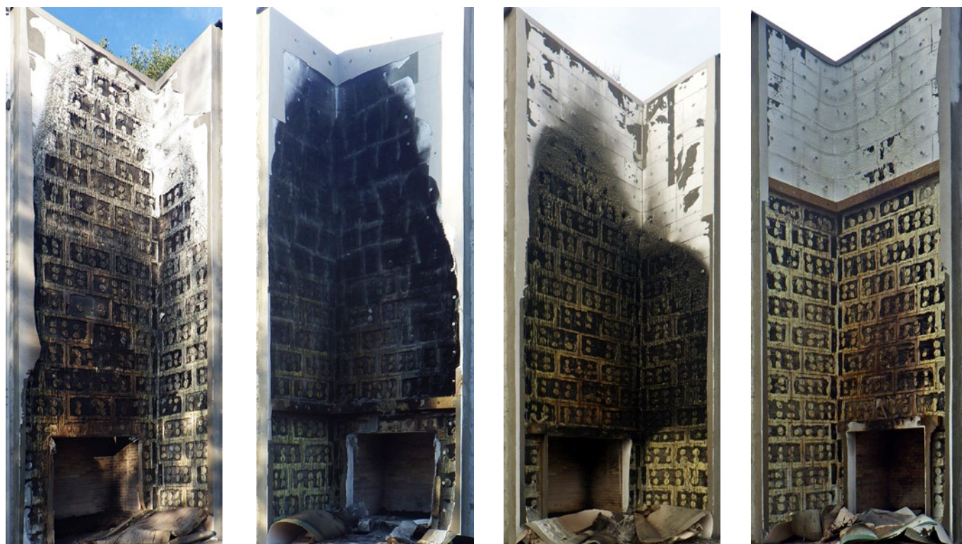
Obr. 4: Čtyři varianty ETICS s EPS a pruhem s MW vystavené požárnímu zatížení dle BS8414-1: 2020-04 v polském Institutu keramiky a stavebních materiálů po ukončení zkoušky a odkrytí základní vrstvy ETICS. Zdroj: prezentace Michała Wieczorka „Badania ogniowe ścian zewnętrznych budynków w dużej skali“ na polské mezinárodní konferenci ETICS 2021.
