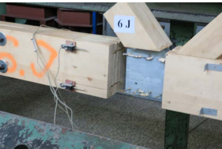
Obr. 8 Styčník po přetržení ve zkušební laboratoři ČVUT, Kloknerův ústav Praha
