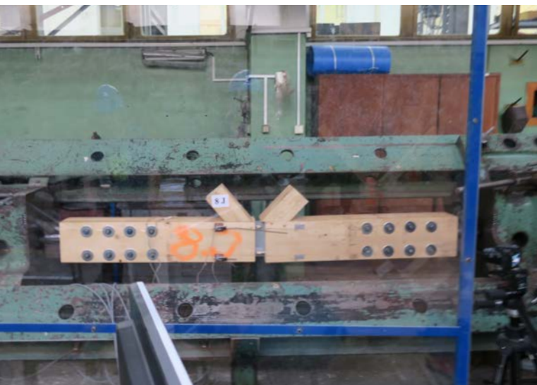
Obr. 6 Začátek zatěžovací zkoušky styčnicku ve zkušební laboratoři ČVUT, Kloknerův ústav Praha
