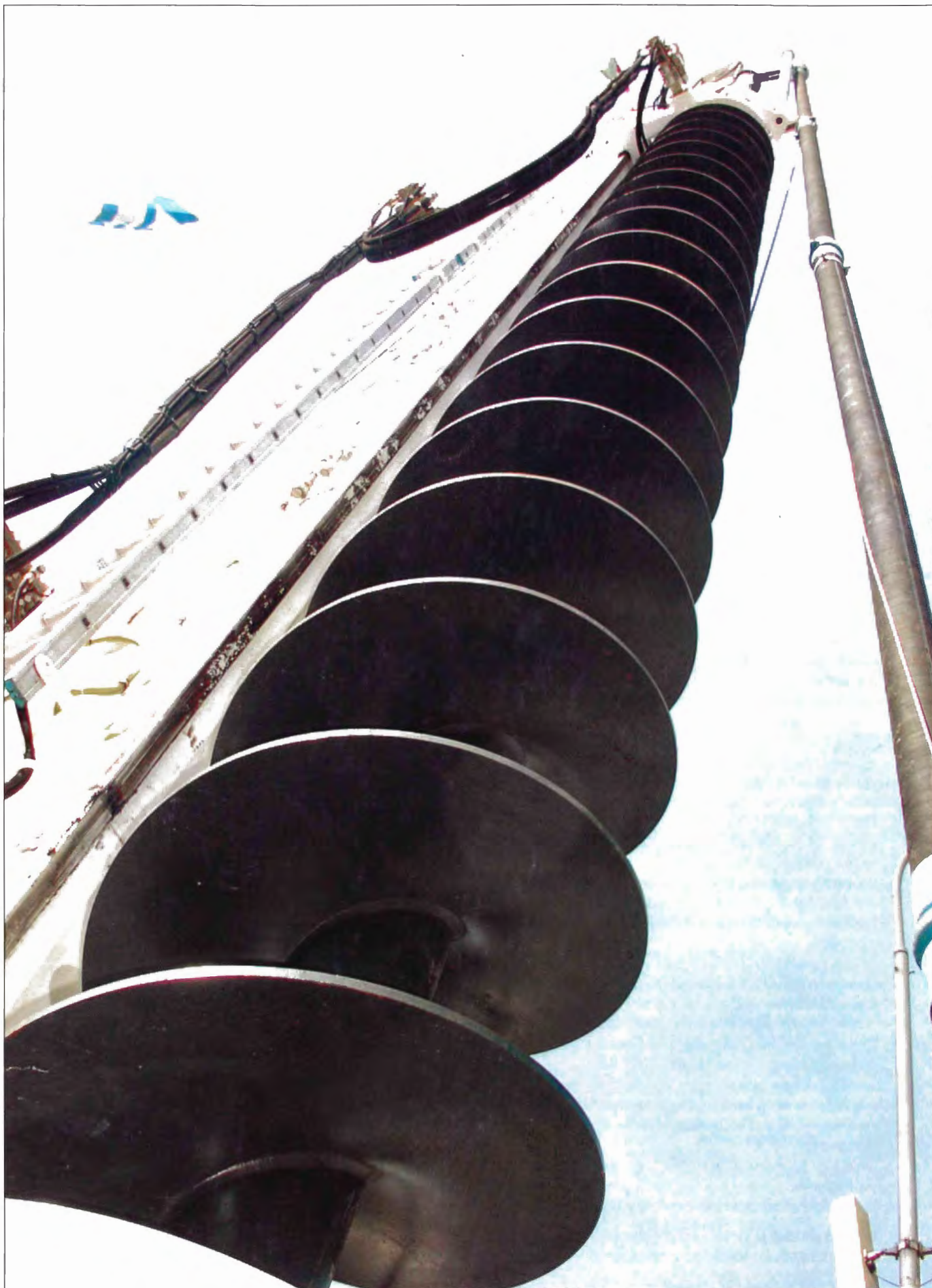
V roce 2002 byla na stavebním veletrhu v Brně vystavena tato vrtná souprava SOILMEC 516 k vrtání pilot o průměru 400 – 1 100 mm. Je vhodná do široké škály zemin a měkkých skal typu tufů, vápenců, pískovců a podobných. Pracuje bez otřesů a má výkon 100 až 140 metrů pilot za den.
