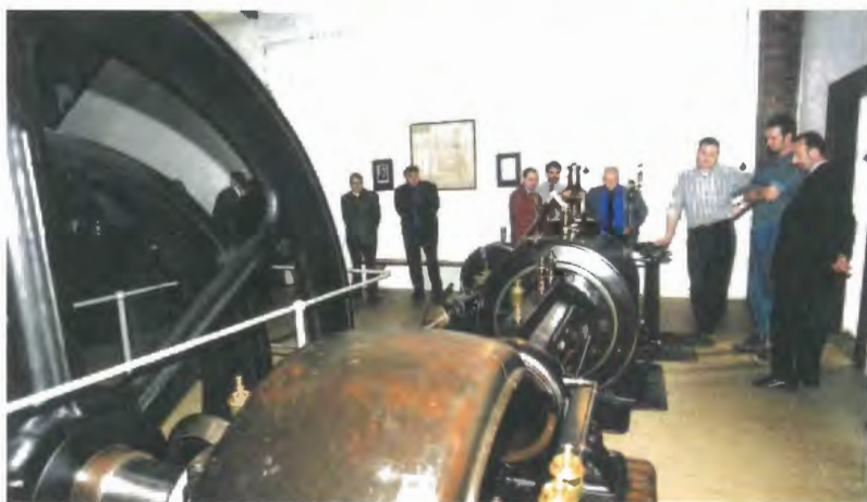
Parní kotelna s transmisemi k pohonu strojního zařízení čistírny ze 30. let, dnes již minulého století, byla předváděna na 1. bienále všem návštěvníkům a pochopitelně i pánům ministrům nejen v plné kráse, ale i v plné funkci. (Uvedení do provozu trvá cca 3 dny).
