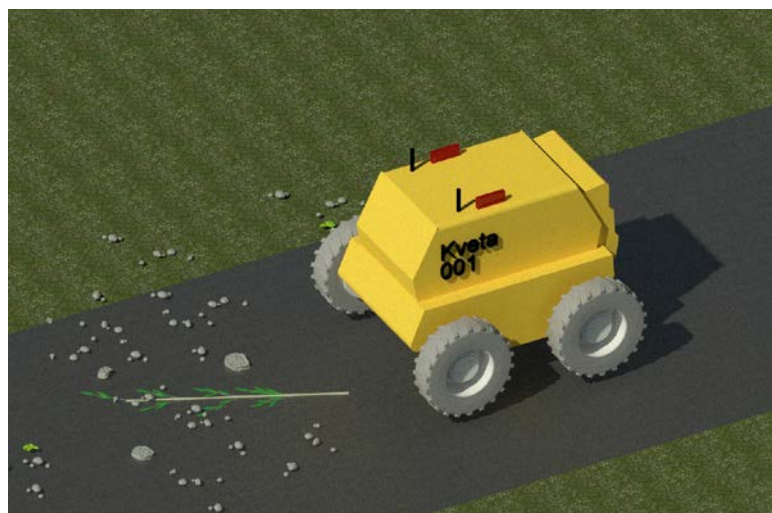
Robot Květa – vítězný návrh prvního robotického systému pro úklid staveniště (zdroj: ČVUT v Praze)
