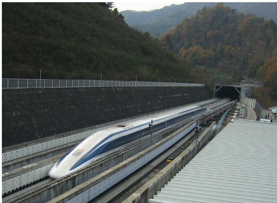
Japonský Maglev pohybující se po speciální trati s polštářem magnetického pole může dosáhnout rychlosti až 600 km/h (foto: Yosemite, wikimedia commons.org)
