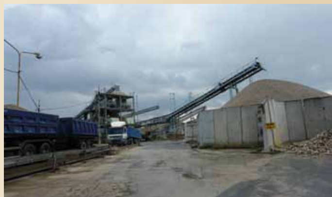
Těžba a třídění štěrků a písků naplavených řekou Moravou v Mohelnici. Fluvialní terasové štěrkopísky jsou vyplaveny z údolí Jeseníků a Zábřežské vrchoviny.
