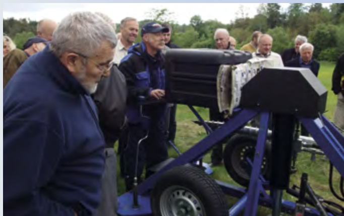
Demonstrace měření hodnot tření zeminy na plášti kotevnicích vrutů při postgraduálu v Rančívově
