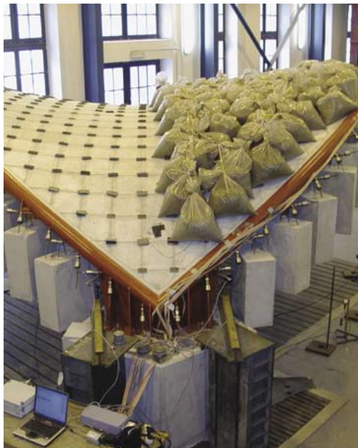
Zatěžovací zkouška modelu.
